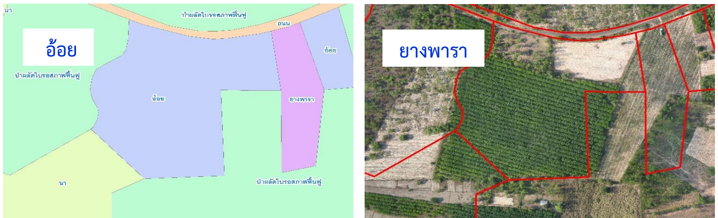
ภาพที่ 11 ภาพถ่ายออร์โธรีจากอากาศยานไร้คนขับเพื่อตรวจสอบการเปลี่ยนแปลงการใช้ประโยชน์ที่ดิน
