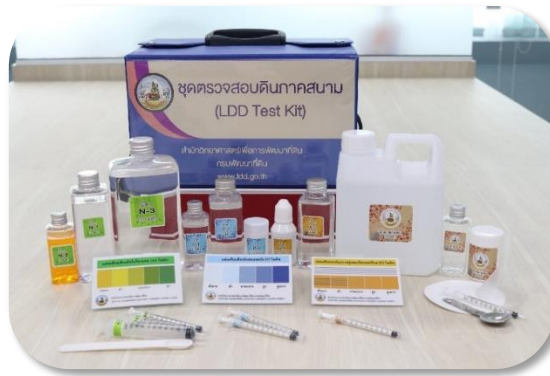
ชุดตรวจสอบธาตุอาหารพืชในดิน NPK Test Kit
